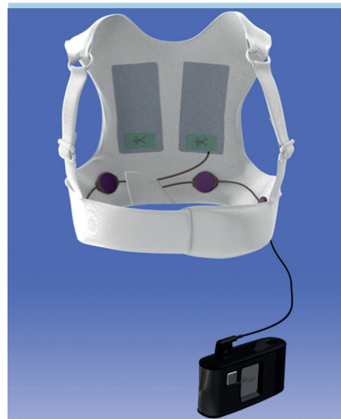
Figura 1. Rappresentazione delle principali parti costituenti il defibrillatore indossabile: la cintura di elettrodi montata sul corpetto in tessuto e collegata al monitor defibrillatore.
